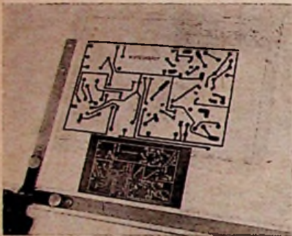
Fig. 6B. Als dit model gereed is, dient er een speciaal cliché van te worden vervaardigd. Voor het drukken is uiteraard een speciale inktsoort nodig.
